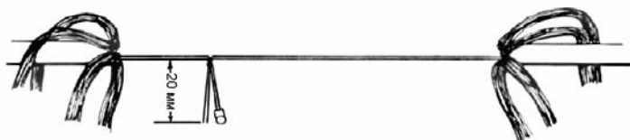
Рис. 5.5. Жилы Б и Б' подготовлены к сращиванию
