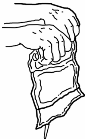
Рис. 15.4. Выдавливание компаунда из пакета
