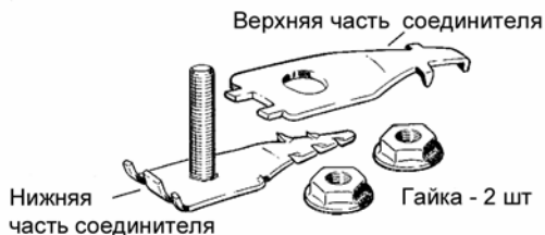
Рис. 4.1. Составляющие экранного соединителя типа 4460-D.
