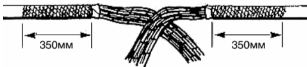
Рис. 9.19. Зоны зачистки оболочек кабеля.
