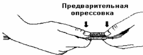
Рис. 13.4. Предварительная опрессовка UDW2.
