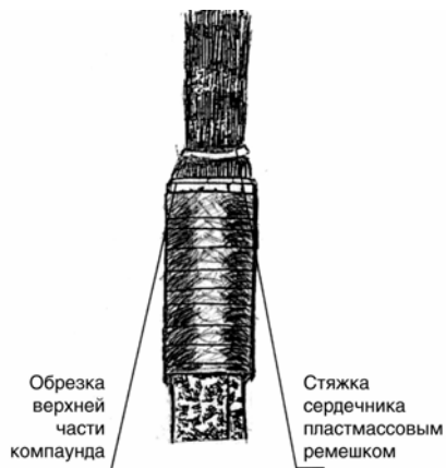
Рис. 10.7. Обрезка отвердевшего компаунда
