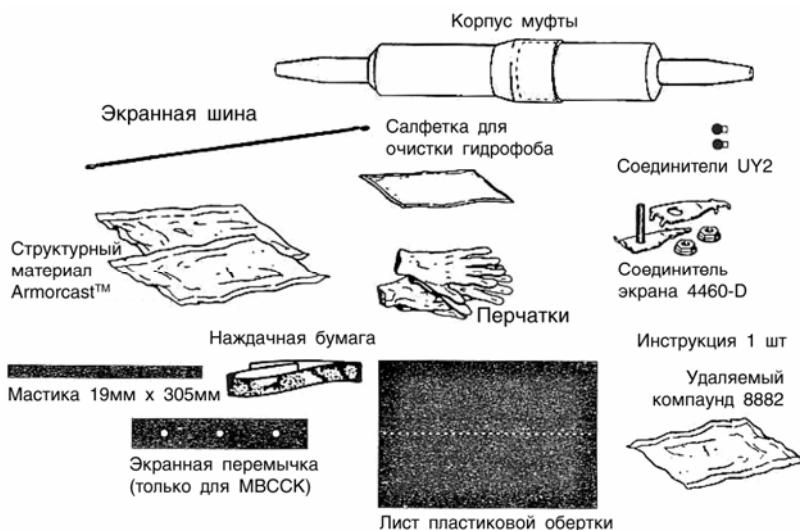
Рис. 9.1. Состав комплекта компрессионных муфт.
