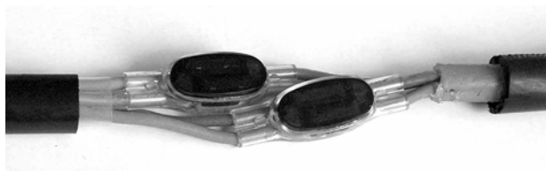
Рис. 12.2 Смонтированные жилы кабеля КСПП
