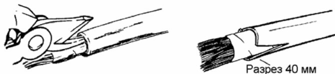
Рис. 4.9. Подготовка кабеля к установке экранного соединителя.
