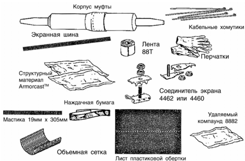
Рис. 10.9. Состав комплекта газонепроницаемой горизонтальной муфты ГНМг.
