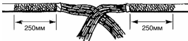
Рис. 9.4. Зоны зачистки оболочек кабеля.
