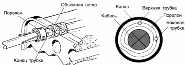
Рис. 14.3. Расположение трубок для заливки компаунда.
