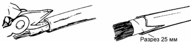
Рис. 4.3. Подготовка кабеля к установке экранного соединителя.
