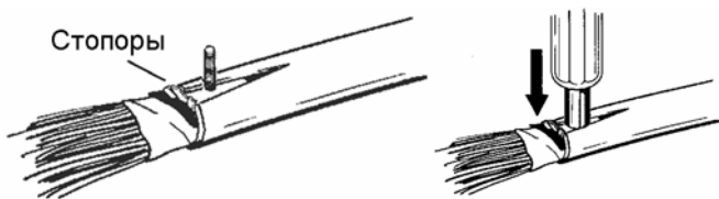
Рис. 4.11. Установка основания экранного соединителя.
