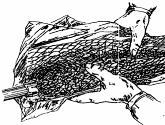
Рис. 9.22. Формирование опалубной сетки.
