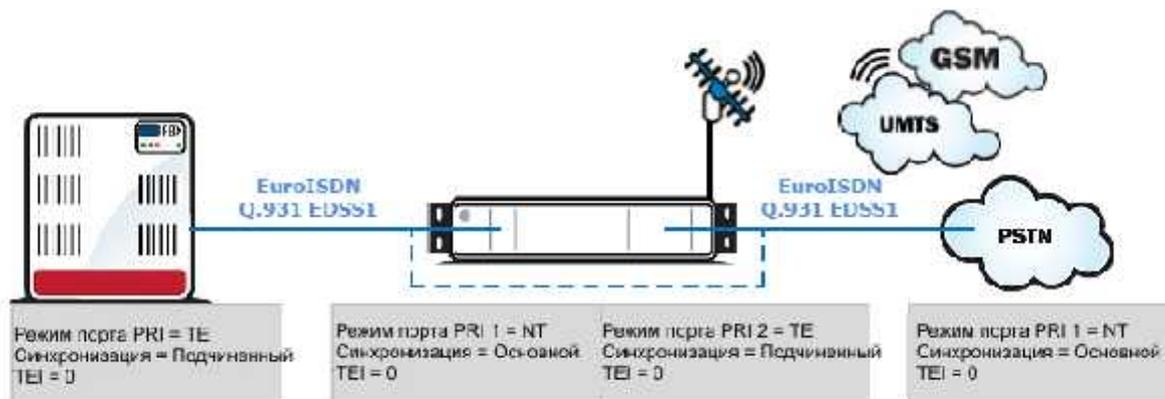
— — — — — соединение ISDN PRI между двумя интерфейсами PRI
