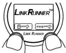
Чтобы перейти в меню настройки функции ping или настройки самого прибора, одновременно нажмите обе кнопки управления (настройки ping или настройки прибора ). Если кабель к прибору не подключен, следует нажать кнопку , и вы перейдете в раздел настроек IP Configuration.
