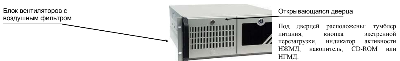
Рис. 4.2.* Системный блок станции записи (исполнение 2), вид спереди.
