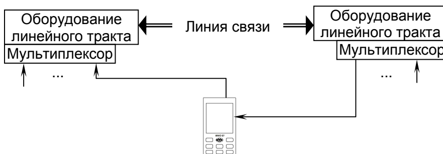
Рис. В1.1. Схема тестирования канала N×64 Кбит/с
