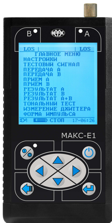
Рис. 4.1. Вид передней панели прибора МАКС-Е1
