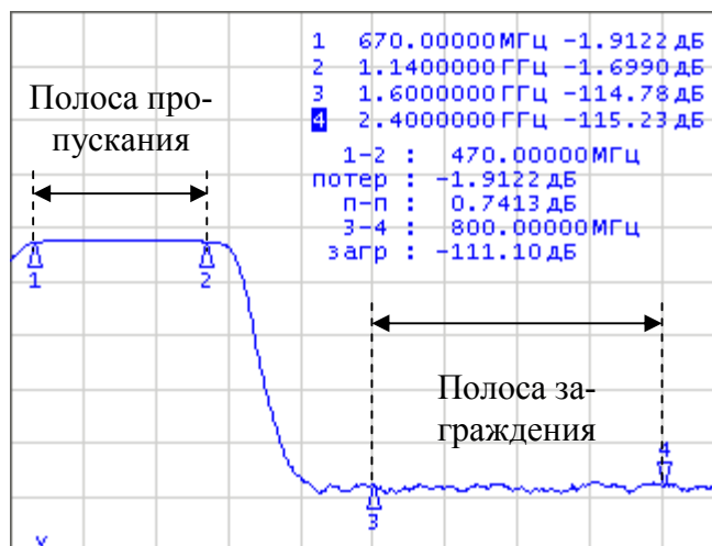
Рисунок 7.12 Функция полосового фильтра
