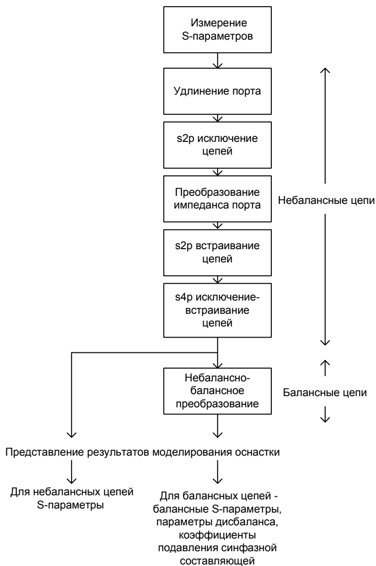
Рисунок 7.14 Схема обработки данных при моделировании оснастки
